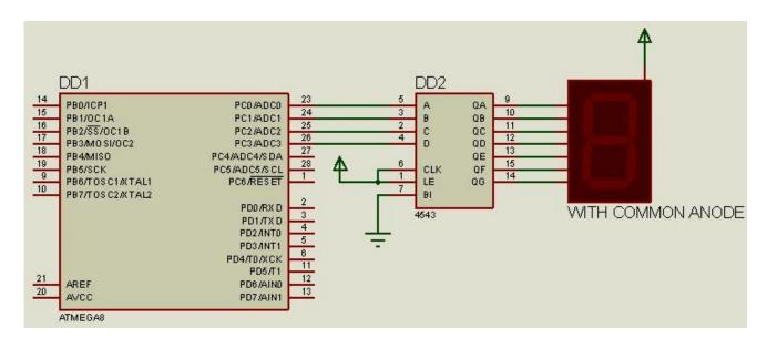
Вывод на индикатор цифр от 0 до 9 с «внешним» семисегментным дешифратором. MK ATMega328P
